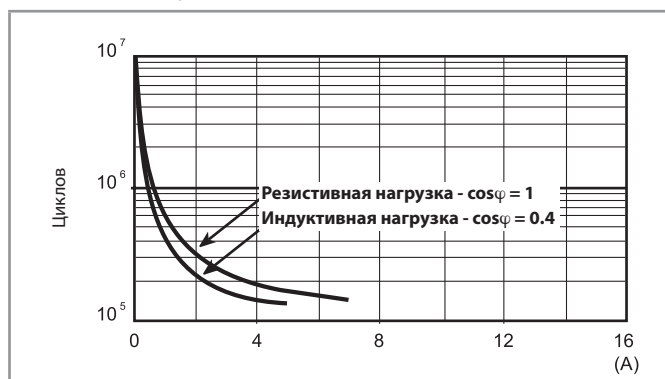
F 58 - Электрическая долговечность (AC) при ном. нагрузке Реле с 4 переключающими контактами
