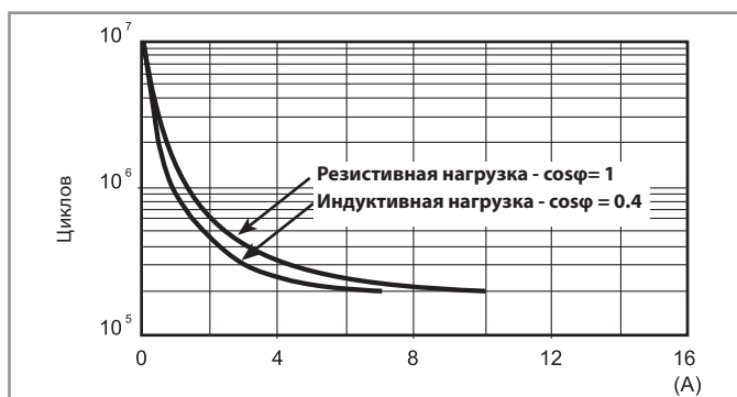
F 60 -Электрическая долговечность (AC) при ном. нагрузке
