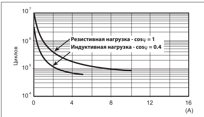
F 7S23 - Электрическая долговечность (AC) при ном. нагрузке 7S.23
