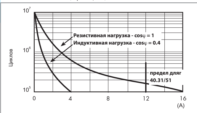
F 40.3 - Электрическая долговечность (АС) при ном. нагрузке Тип 40.31/51/61 (страница 30)
