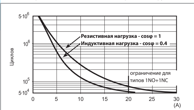
F 65 - Электрическая долговечность (АС) при ном. нагрузке
