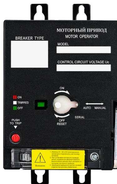
**Моторный привод** предназначен для дистанционного включения, отключения и повторного включения после аварийного срабатывания автоматического выключателя. Моторный привод **устанавливается** на фронтальную часть автоматического выключателя и жёстко **связывает механизм** моторного привода и рычаг управления автоматического выключателя.
